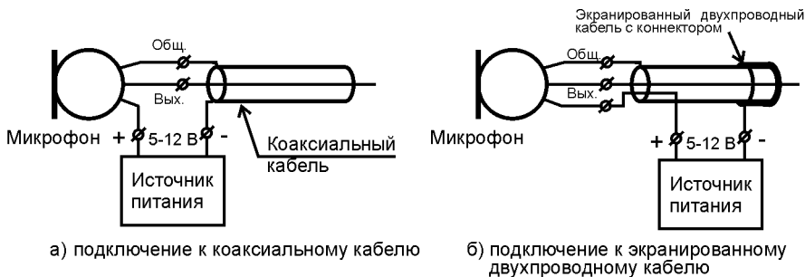
Рисунок 4 – Способы подключения микрофонов
